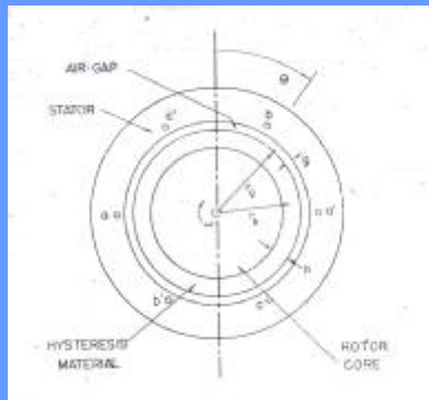
برش عرضی از یک موتور هیستریزیس
